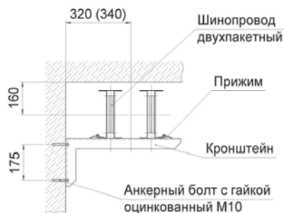
Рисунок 10 - Горизонтальная прокладка одно пакетных шинопроводов на фермах перекрытия, обход препятствий
