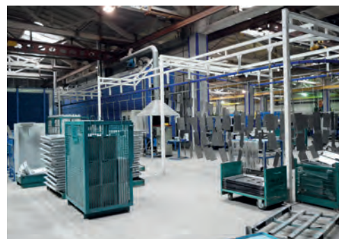
Участок порошковой покраски
