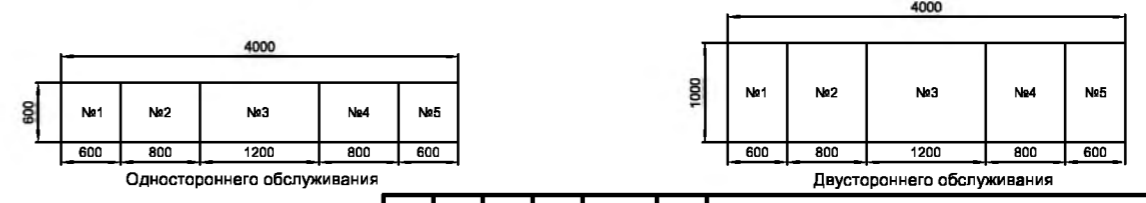
План расположения панелей ГРЩ (1 : 50)
