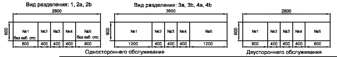
План расположения панелей ГРЩ (1 : 50)
