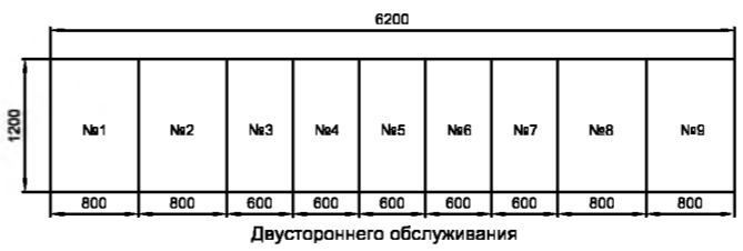
План расположения панелей ГРЩ (1 : 50)
