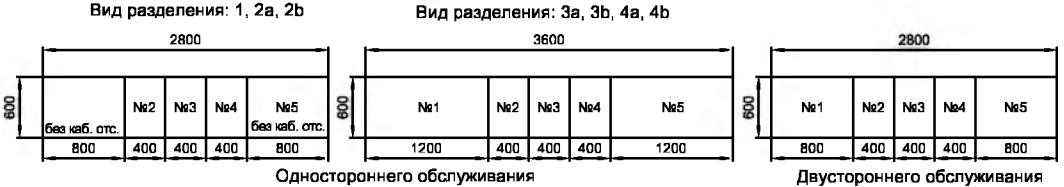
План расположения панелей ГРЩ (1 : 50)
