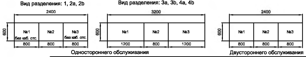
План расположения панелей ГРЩ (1 : 50)
