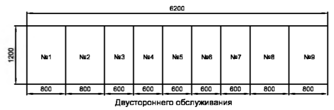
План расположения панелей ГРЩ (1 : 50)
