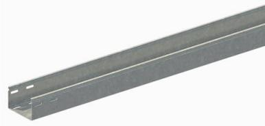
Металлические монтажные лотки ЛМс предназначены для прокладки проводов и кабелей напряжением до 1000В и применяются для выполнения магистральных участков сетей, стояков, мостиков, ответвлений и спусков от основных лотковых трасс.
