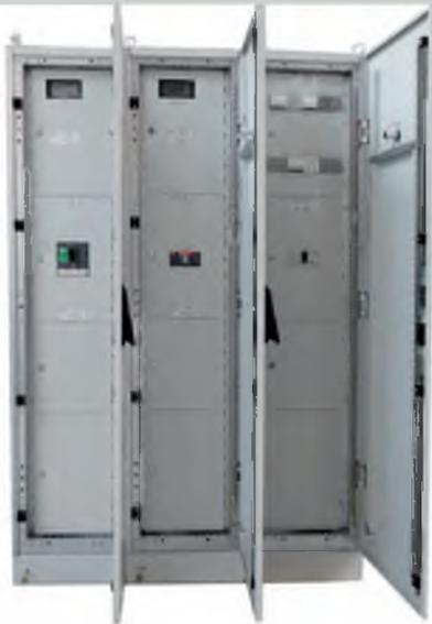
Вводная панель 250А на 3 ввода с АВР на контакторах и учетом электроэнергии. Подвод питания сверху
