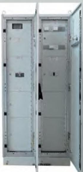
Вводная панель на 2 ввода 250А с АВР на контакторах и учетом электроэнергии.
